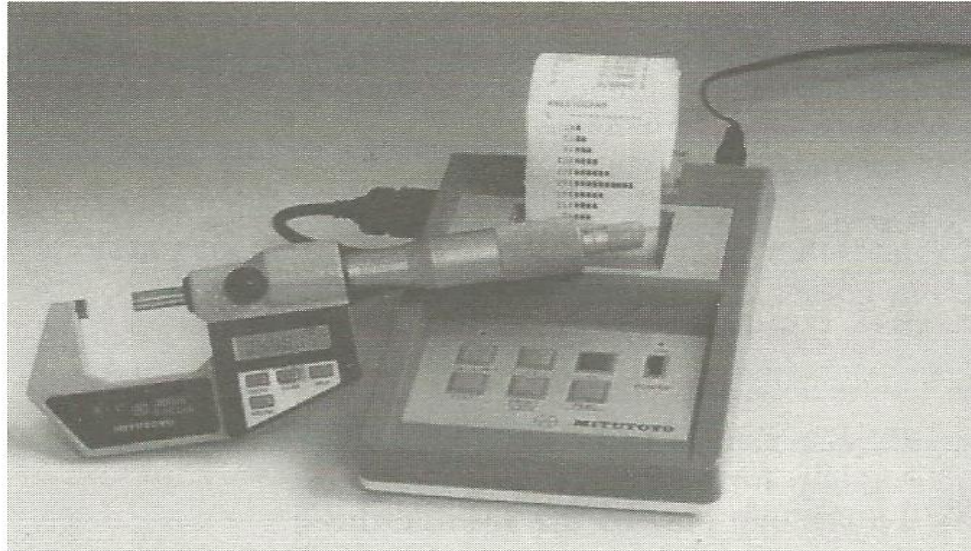
■ Figura 9-16 El micrómetro Digi-Matic con control estadístico de procesos es un procesador de datos en miniatura. (MTI Corp.)
