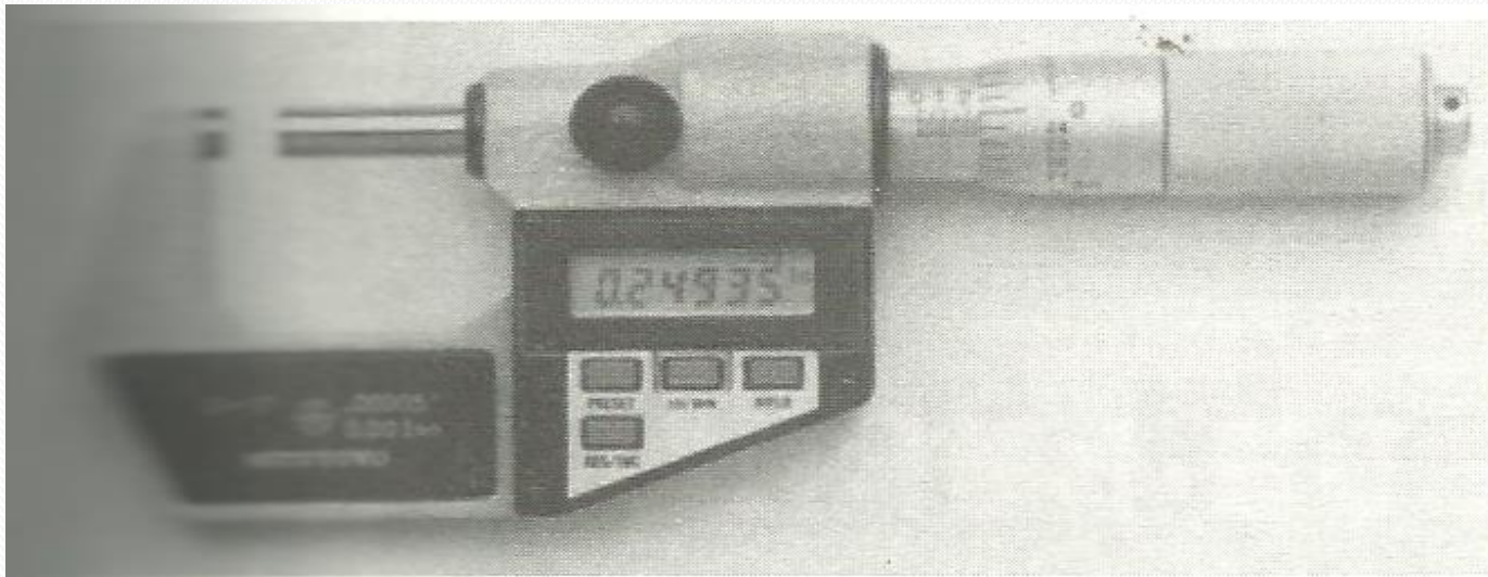
Figura 9-15 El micrómetro Digi-Matic tiene una visualización digital de lectura con una precisión de hasta 50 milésimos de pulgada. (MTI Corp.)
