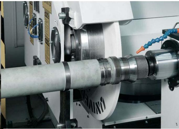
Rectificadora cilíndrica de exteriores
